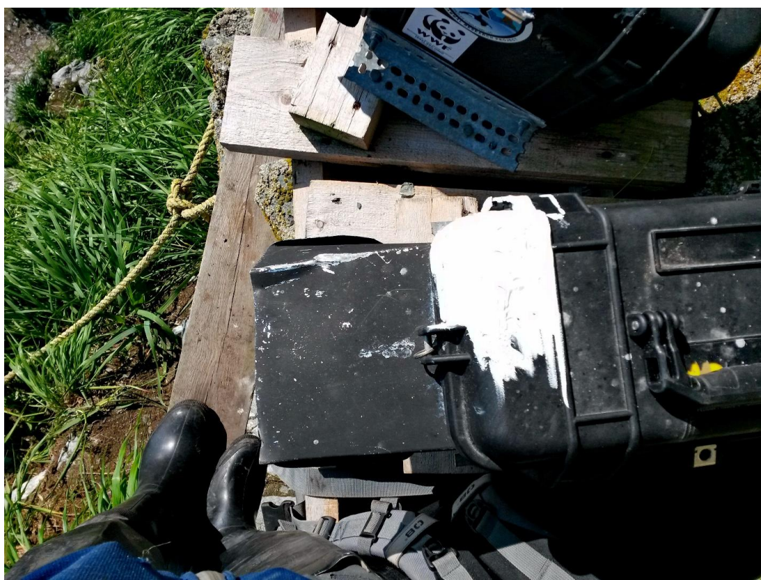
Рисунок 18. Влагозащитный ящик «Пеликан» после ремонта специальным герметиком.
