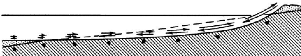
Рис. 27. Профиль динамического равновесия подводного берегового склона, сложенного наносами одинаковой крупности (по В.П. Зенковичу)
