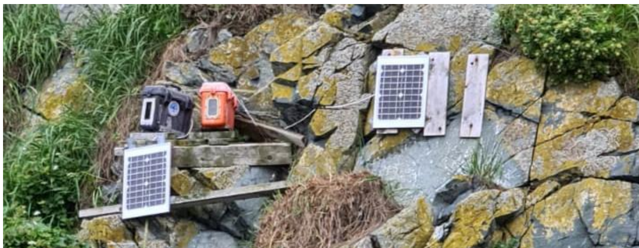
Рис. 6. Регистраторы № 3 (справа) и № 4 (слева) после обслуживания.
