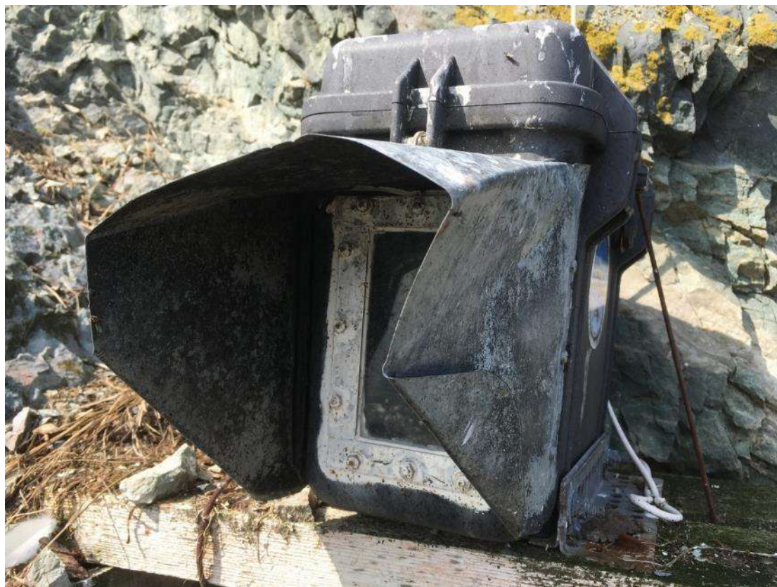
Рис.3. Внешний вид регистратора № 2 до обслуживания. Защищавшая стекло бленда согнута от напора ветра. Была демонтирована.
